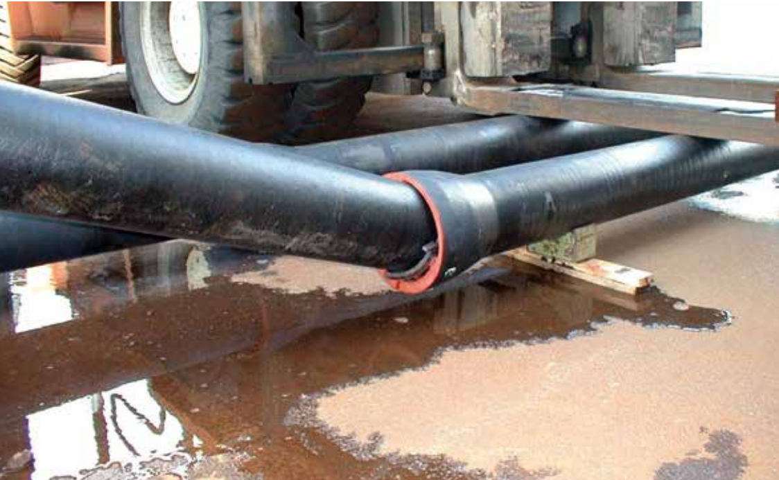
Test de deviație: îmbinare sigură până la 24°
