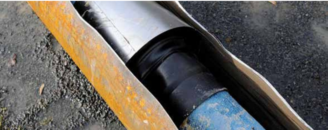
O conductă din oțel spartă
